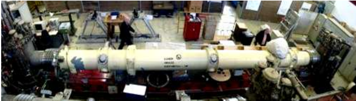
Obr. 8.12 Jeden z dipólových magnetů, použitých v experimentu ALPS.
