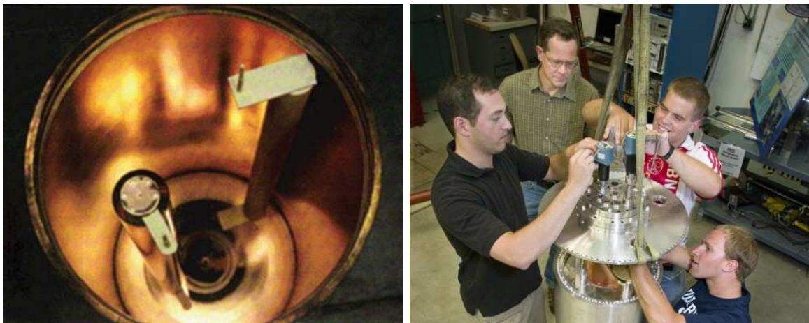
Obr. 8.10: Vlevo: pohled shora na rezonanční dutinu, jejíž průměr je 50 cm a výška 1 m. Vnitřek dutiny je potažen mědí a obsahuje dvě ladicí tyče. Vpravo: osazování horní části detektoru.
